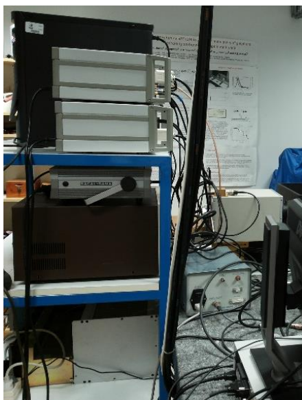
Сурет 19 – Уақыт бойынша ажыратымды өлшеулер жүргізуге арналған қондырғы жүйесі (TCSPC, Fluofit)
